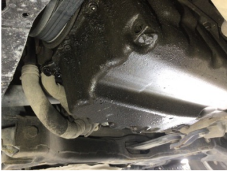
Motor, Motor > Yağ Kaçağı
