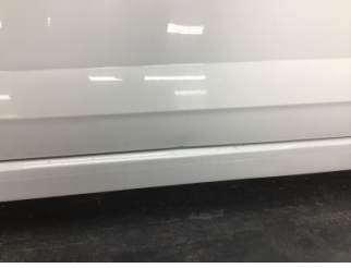
Kapı, sol ön, Kapı, sol ön > Ezik
