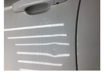
Kapı, sol ön, Kapı, sol ön > Ezik
