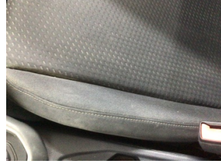
Koltuklar, ön, Koltuk, sağ ön > Deforme Olmuş
