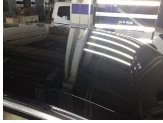
Tavan, Tavan > Dolu Hasarı
