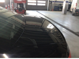
Bagaj kapağı/kapısı, Bagaj kapısı > Noktasal Ezik
