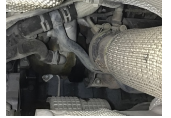
Motor, Turbo > Yağ Kaçağı
