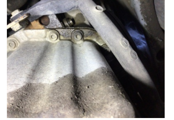
Motor, Yağ karteri > Yağ Kaçağı
