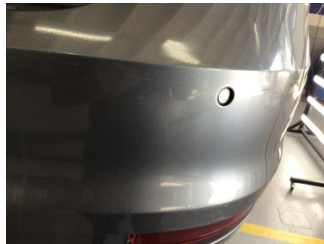
Tampon, arka, Park sensörü, sağ > Hasarlı
