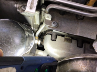
Motor, Triger zinciri kapağı > Yağ Kaçağı
