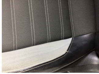
Koltuklar, ön, Koltuk, sol ön > Deforme Olmuş
