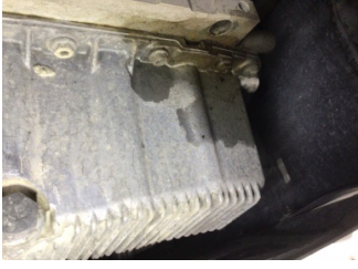
Motor, Yağ karteri > Yağ Kaçağı
