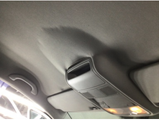
Döşemeler/Kapaklar, Tavan döşemesi > Deforme Olmuş
