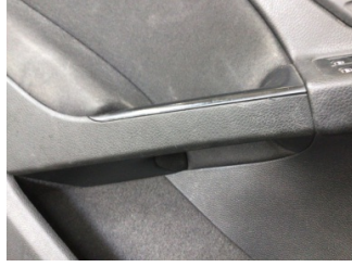
Döşemeler/Kapaklar, Kapı döşemesi, sağ ön > Deforme Olmuş
