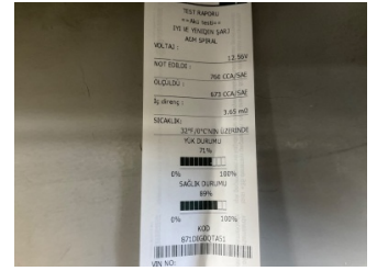
Elektrik donanımı/Pano, Akü > Test Sonucu
