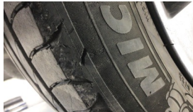
Lastik, ön > Hasarlı
