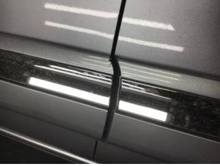
Kapı, sol ön, Kapı bandı > Çizik
