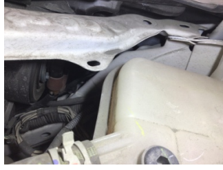
Çamurluk, sağ, Bağlantı ayağı > Ezik
