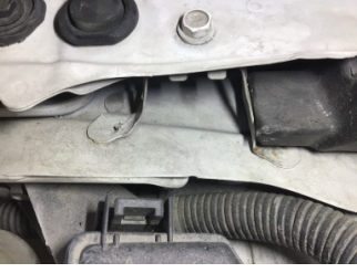
Çamurluk, sağ, Bağlantı ayağı > Ezik
