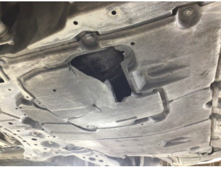
Motor, Alt muhafaza > Hasarlı
