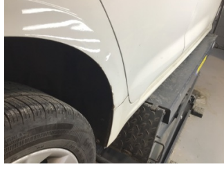
Çamurluk, sağ arka, Çamurluk, sağ arka > Ezik
