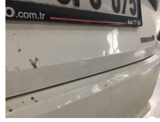
Bagaj kapağı/kapısı, Bagaj kapısı > Ezik
