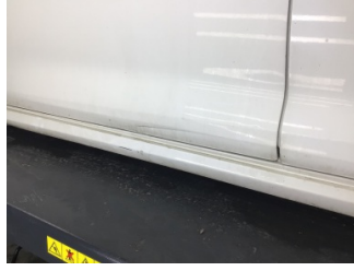
Kapı, sol ön, Kapı, sol ön > Ezik
