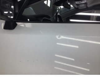
Kapı, sol ön, Kapı, sol ön > Ezik
