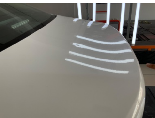
Bagaj kapağı/kapısı, Bagaj kapısı > Noktasal Ezik
