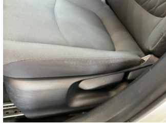
Döşemeler/Kapaklar, Döşemeler/Kapaklar > Deforme Olmuş
