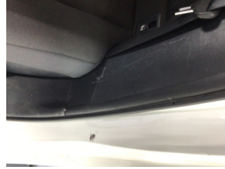
Döşemeler/Kapaklar, Döşemeler/Kapaklar > Çizik
