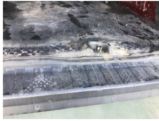
Arka bölüm, Bagaj kapağı fitili > Deforme Olmuş
