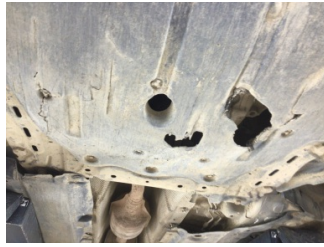
Motor, Alt muhafaza > Hasarlı
