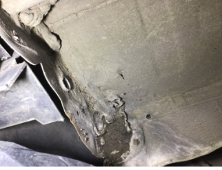
Arka bölüm, Bagaj havuzu > Hasarlı
