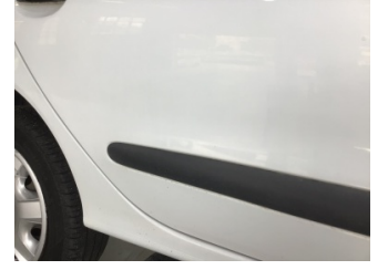
Kapı, sağ arka, Kapı, sağ arka > Ezik
