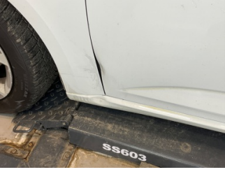
Marşbiyel, sağ, Marşbiyel, sağ > Hasarlı
