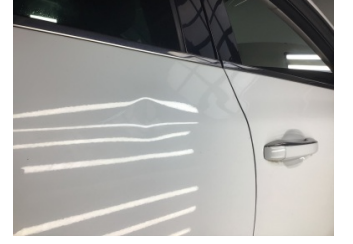
Kapı, sağ arka, Kapı, sağ arka > Ezik
