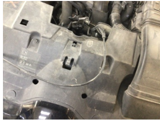
Motor kaputu, Açma Mandalı Dış > Hasarlı
