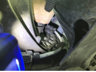
Ön aks, Aks mili, sol > Yağ Kaçağı
