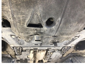
Motor, Alt muhafaza > Hasarlı
