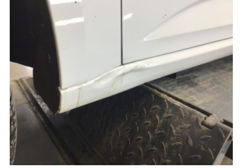
Marşbiyel, sol, Marşbiyel, sol > Hasarlı
