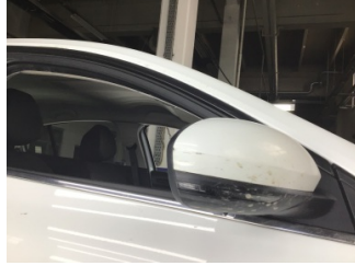
Dikiz aynası, sağ, Dış dikiz aynası > Çizik
