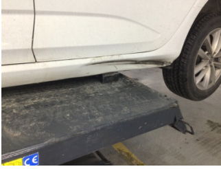
Marşbiyel, sol, Marşbiyel, sol > Hasarlı
