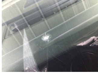
Camlar, Ön cam > Hasarlı
