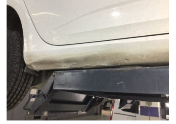
Marşbiyel, sağ, Marşbiyel, sağ > Hasarlı
