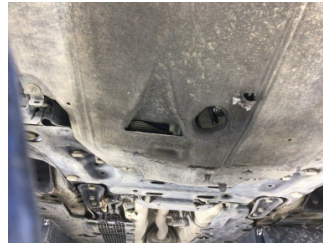
Motor, Alt muhafaza > Hasarlı
