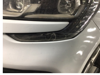
Farlar, Far, sol > Hasarlı
