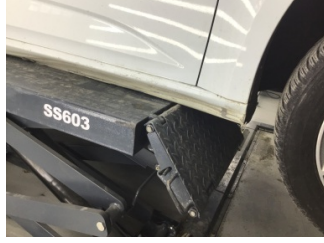
Marşbiyel, sağ, Marşbiyel, sağ > Hasarlı
