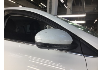
Dikiz aynası, sağ, Dış dikiz aynası > Çizik
