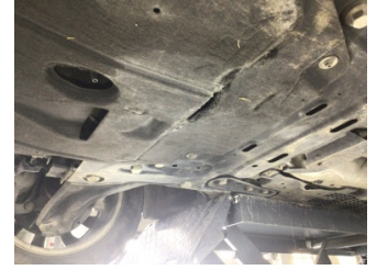
Motor, Alt muhafaza > Hasarlı
