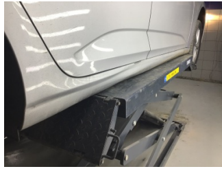
Marşbiyel, sağ, Marşbiyel, sağ > Hasarlı
