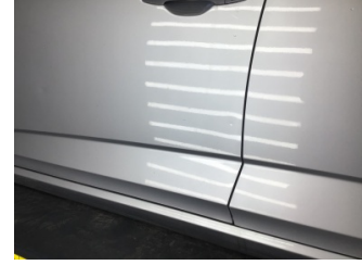
Kapı, sol ön, Kapı, sol ön > Ezik
