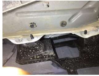
Çamurluk, sol arka, Çamurluk, sol arka > Standart Dışı Onarım
