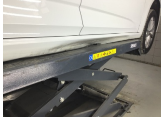
Marşbiyel, sağ, Marşbiyel, sağ > Hasarlı
