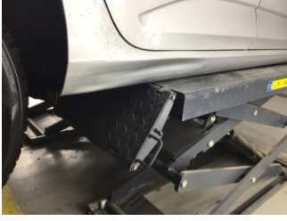
Marşbiyel, sağ, Marşbiyel, sağ > Hasarlı
