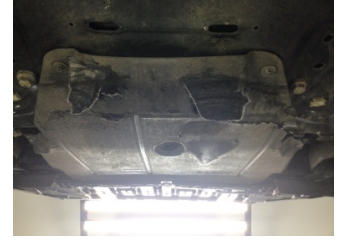
Motor, Alt muhafaza > Hasarlı
