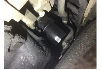
Motor, Yağ filtresi muhafazası > Yağ Kaçağı
