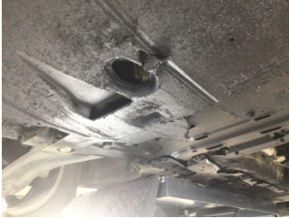
Motor, Alt muhafaza > Hasarlı
