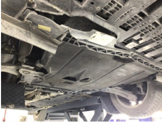
Motor, Alt muhafaza > Hasarlı
