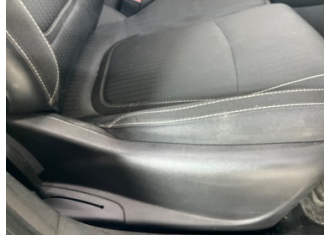
Koltuklar, ön, Koltuk döşemesi, sağ ön > Yıpranmış
