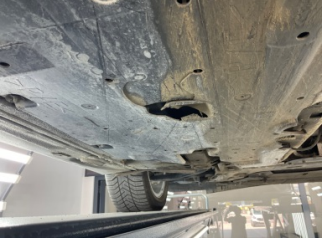
Kaporta, Muhafaza, orta > Hasarlı
