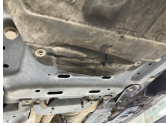
Motor, Alt muhafaza > Hasarlı
