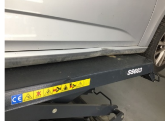
Marşbiyel, sağ, Marşbiyel, sağ > Hasarlı
