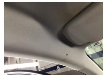
Döşemeler/Kapaklar, Tavan döşemesi > Kirlenmiş
