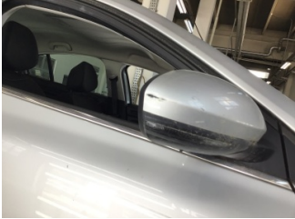
Dikiz aynası, sağ, Dış dikiz aynası > Çizik
