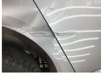
Kapı, sağ arka, Kapı, sağ arka > Ezik
