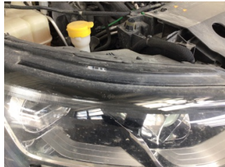
Farlar, Far camı, sağ > Deforme Olmuş
