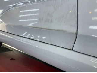
Kapı, sağ arka, Kapı, sağ arka > Çizik
