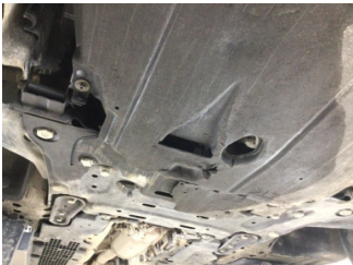
Motor, Alt muhafaza > Hasarlı
