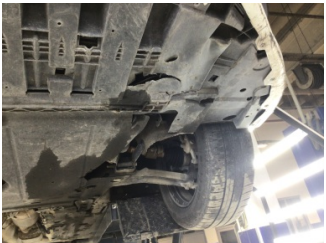
Motor, Alt muhafaza > Hasarlı
