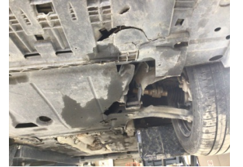
Motor, Alt muhafaza > Hasarlı
