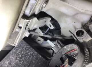
Çamurluk, sağ, Bağlantı ayağı > Ezik
