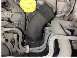
Motor, Turbo hortumları > Yağ Kaçağı
