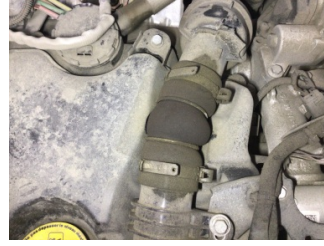
Motor, Turbo hortumları > Yağ Kaçağı
