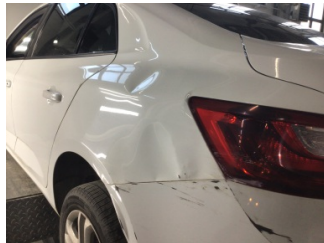
Çamurluk, sol arka, Çamurluk, sol arka > Hasarlı
