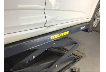
Marşbiyel, sağ, Marşbiyel, sağ > Hasarlı
