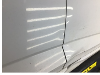
Kapı, sağ arka, Kapı, sağ arka > Ezik
