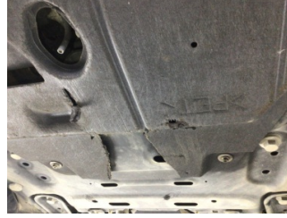
Motor, Alt muhafaza > Hasarlı
