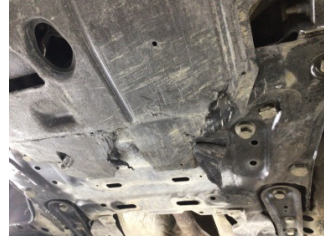
Motor, Alt muhafaza > Hasarlı
