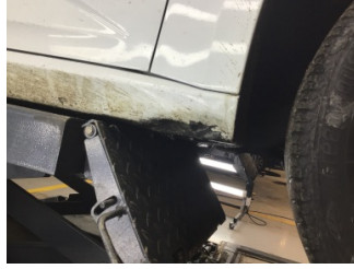
Marşbiyel, sağ, Marşbiyel, sağ > Hasarlı
