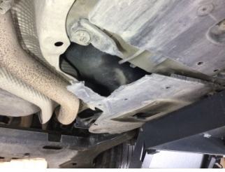
Motor, Alt muhafaza > Hasarlı
