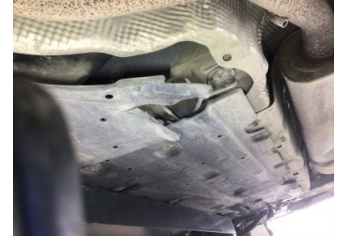
Motor, Alt muhafaza > Hasarlı
