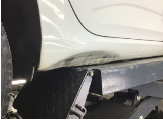
Marşbiyel, sağ, Marşbiyel, sağ > Hasarlı
