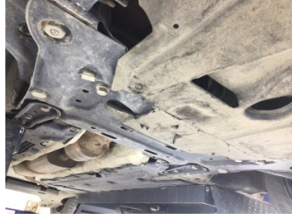
Motor, Alt muhafaza > Hasarlı
