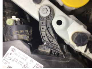
Farlar, Far, sağ > Standart Dışı Onarım
