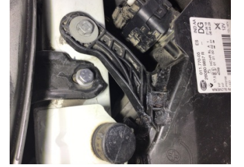
Farlar, Far, sol > Hasarlı
