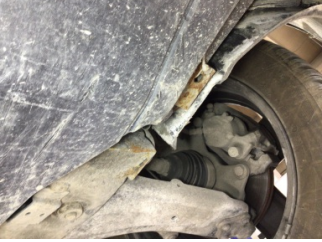
Motor, Alt muhafaza > Hasarlı
