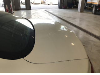
Bagaj kapağı/kapısı, Bagaj kapısı > Noktasal Ezik
