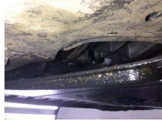
Şanzıman, Şanzıman > Yağ Kaçağı
