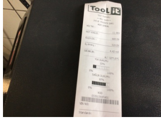
Elektrik donanımı/Pano, Akü > Test Sonucu
