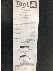
Elektrik donanımı/Pano, Akü > Test Sonucu
