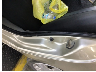
Kapı, sol arka, Kapı fitili > Hasarlı
