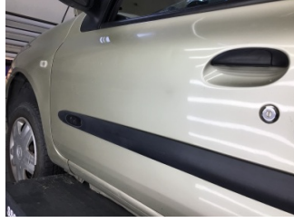
Kapı, sol ön, Kapı, sol ön > Ezik
