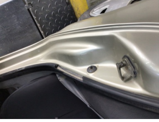
Kapı, sağ arka, Kapı fitili > Hasarlı
