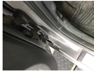
Kapı, sol ön, Kapı gergisi > Ses Yapıyor
