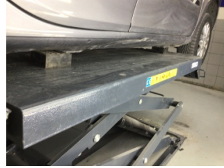
Marşbiyel, sağ, Marşbiyel, sağ > Hasarlı
