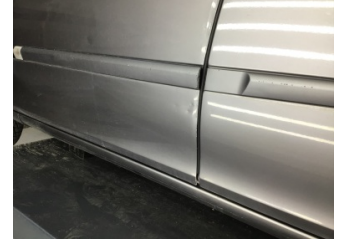
Kapı, sol ön, Kapı, sol ön > Ezik
